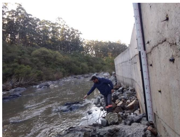
Figura 9 - Coleta de amostra para análise de sólidos em suspensão com o amostrador DH-48. Fonte: Ecosystem, 2021.
