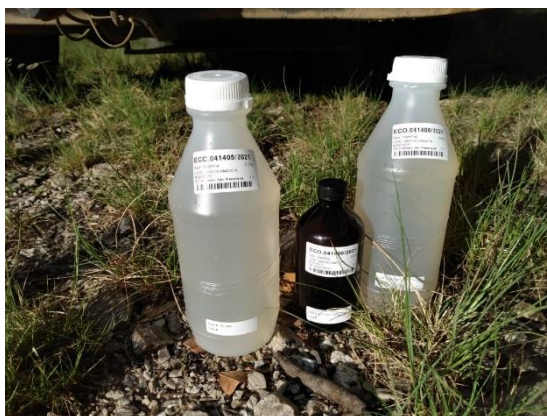
Figura 6 - Frascaria disponibilizada pelo laboratório com as amostras de água superficial coletadas. Fonte: Ecossis, 2021.
